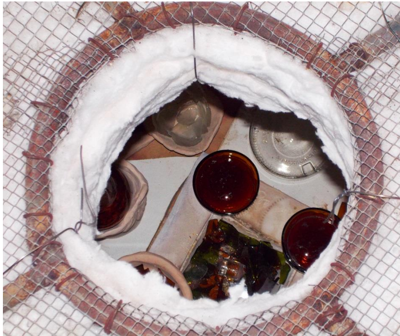
Figura 50. Disposición de botellas cortadas y molienda dentro del horno. Fuente: La Autora.
