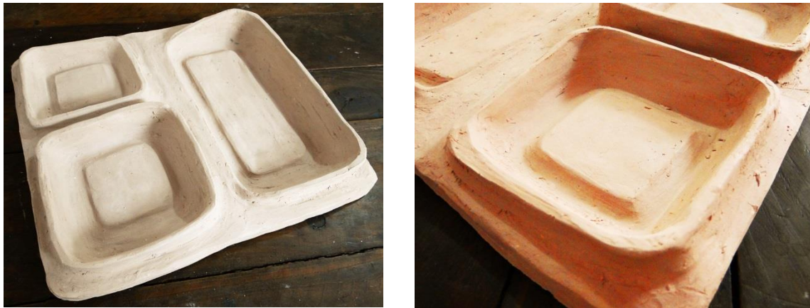
Figura 69. a Molde en arcilla en crudo. b Molde en arcilla cocida.
