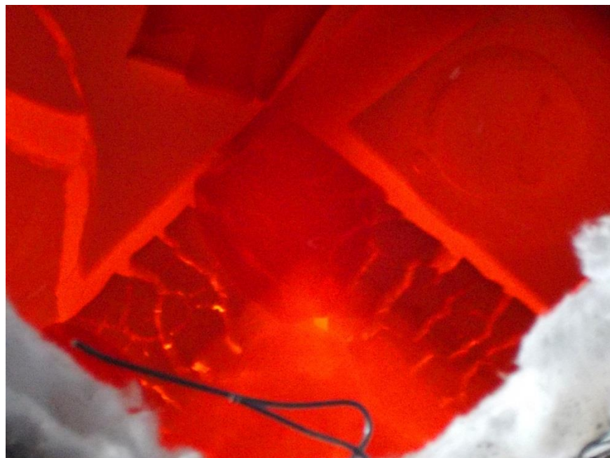
Figura 52. Quiebra de molde en yeso a 900°C. Fuente: La Autora.
