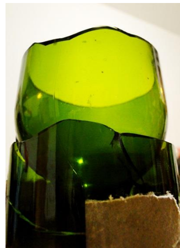
Figura 71. a Corte simple con cortador de vidrio lubricado. b Corte simple mal trazado aplicando calor. Fuente: La Autora.
