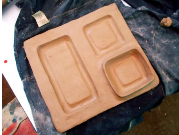
Figura No. 45. Molde para modelos funcionales a escala 1:2.
