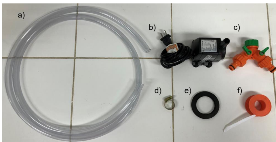
Figura 7. Componentes adicionales para realizar el ensamblaje del tren de tratamiento. a) Manguera plástica; b) Bomba de agua; c) Conexión tipo “Y”; d) Abrazadera de metal; e) Empaques; f) Cinta de teflón.
