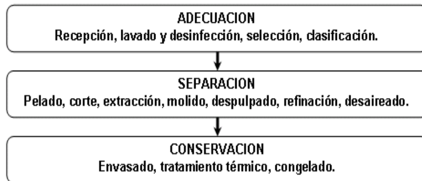
Figura 37. Diagrama de flujo de operaciones para la elaboración de pulpas de frutas congeladas
