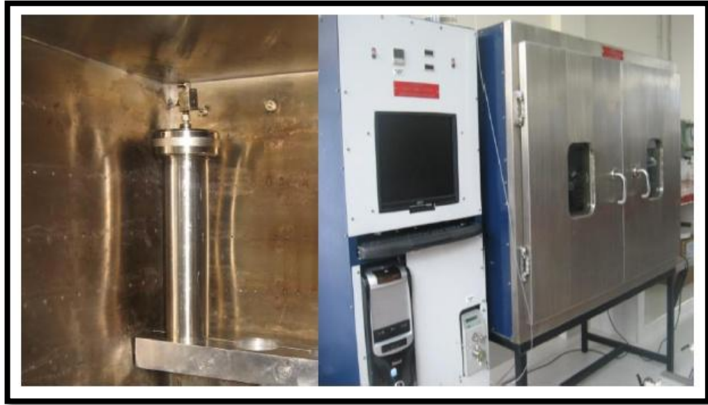
Figura 26. Equipo de desplazamiento (Liquid Flood System), CORE PET.
