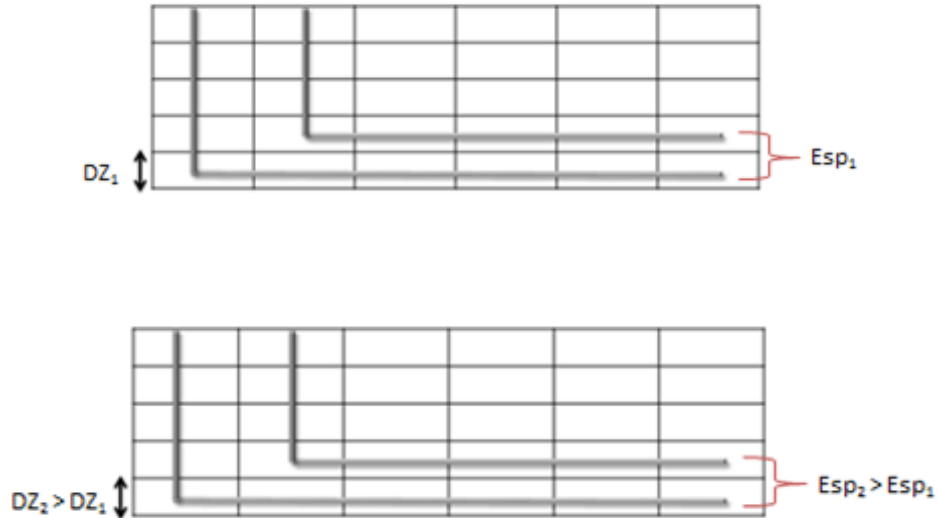
Figura 39 Cambio en la posición de los pozos al modificar el tamaño de bloque
