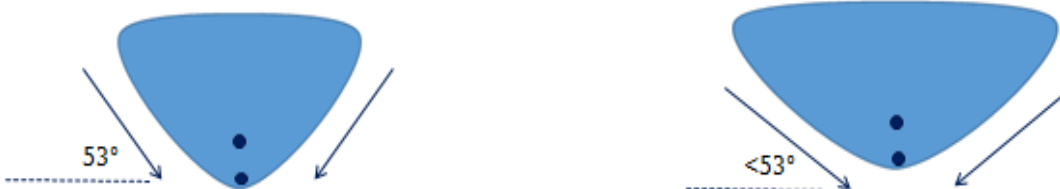
Figura 26 Efecto de la expansión de la cámara de vapor sobre el drenaje de fluidos.
