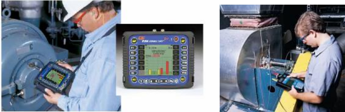
Figura 15. Medición de vibraciones
