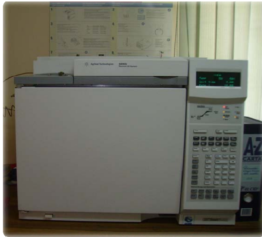
Figura 17 Cromatógrafo Agilent Technologies 6890 Network Series GC- acoplado a un detector FID
