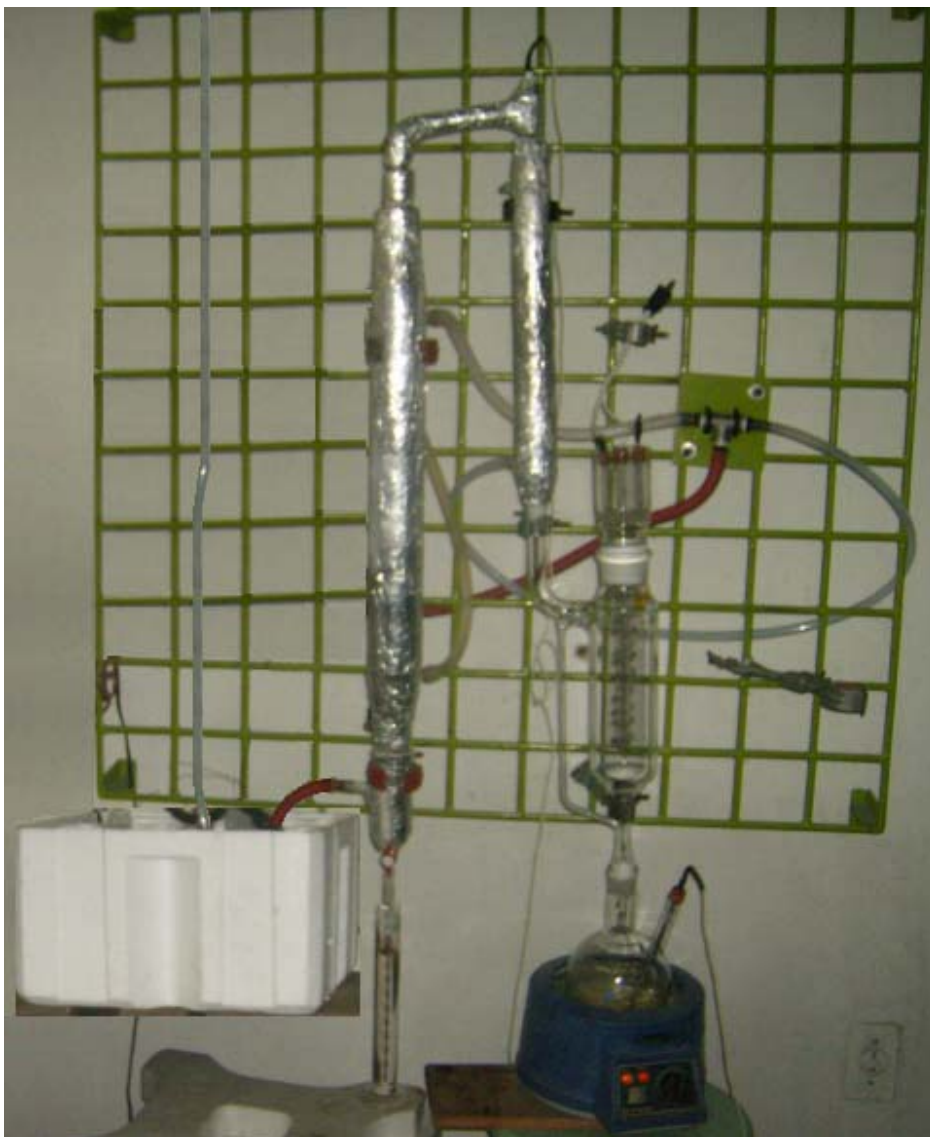
Figura 4. Montaje instalado para la producción de cetena por pirólisis de la acetona
