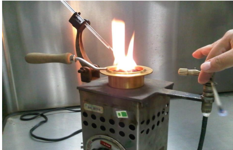
Figura 7 Fotografía prueba flash point
