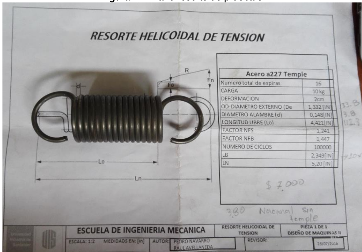
Figura 74. Plano resorte de prueba 3.
