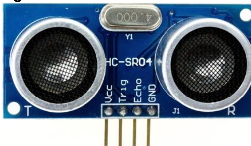
Figura 52. Sensor ultrasonido HS04.
