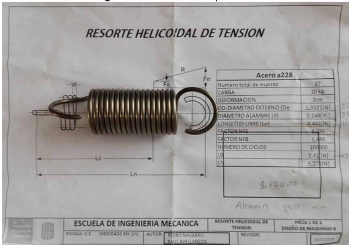
Figura 72. Plano resorte de prueba 3.
