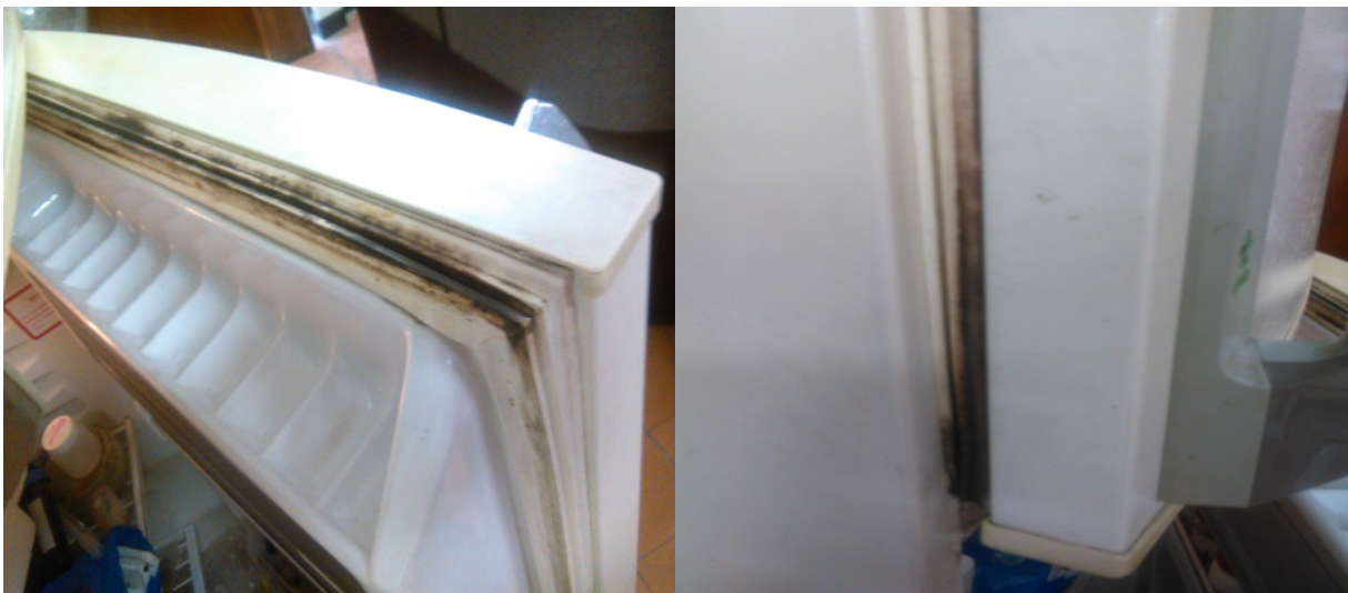
Figura 5.15: Deterioro de empaques en neveras
