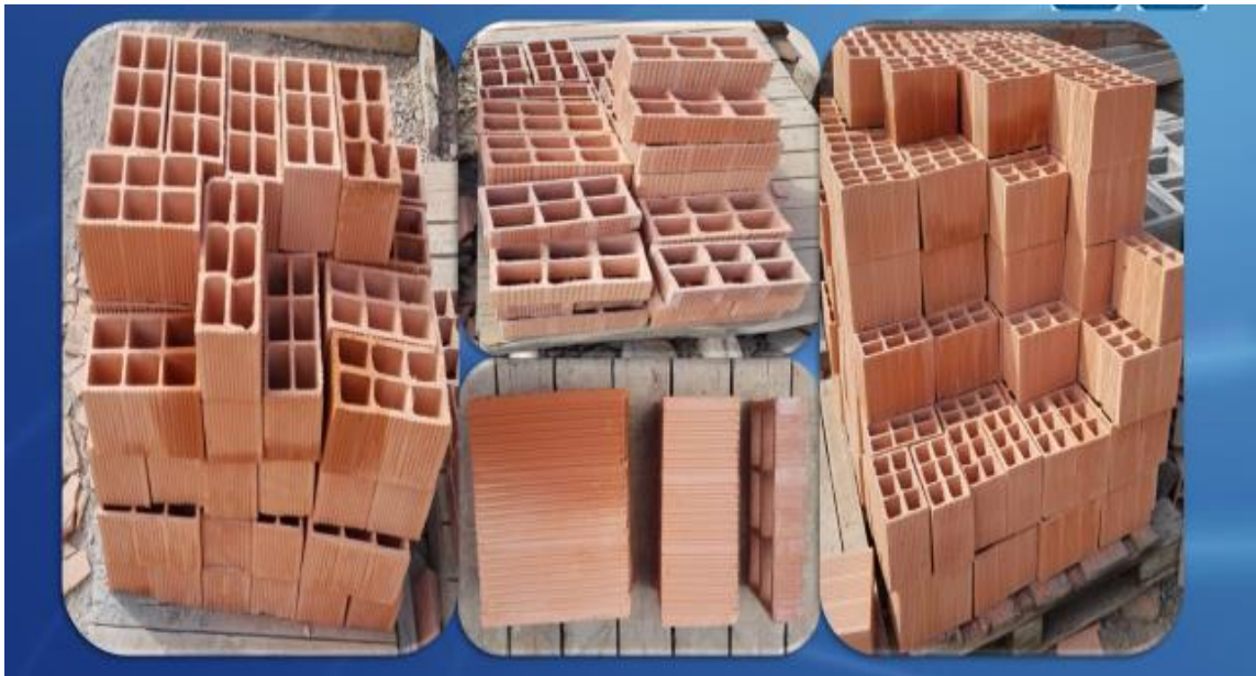
Figura 25. Modulacion de bloque de mampostería
