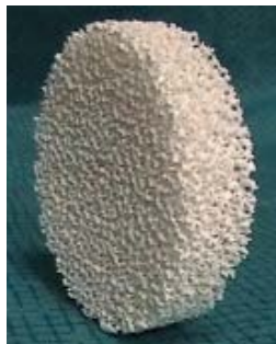
Figura 1. Estructura típica de un monolito tipo espuma
