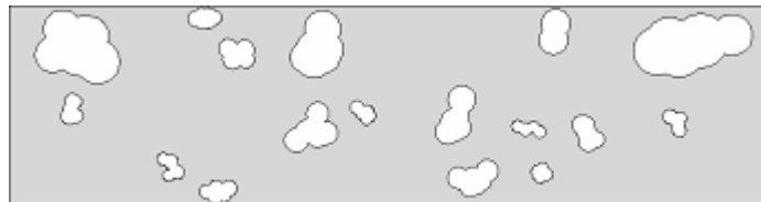
Figura 10. Modelo geométrico generado a partir de datos estadísticos de distribución de tamaño de sólidos
