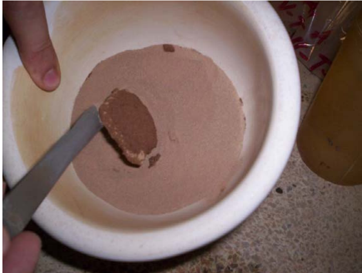
Figura 24, Muestra para límite Plástico.
