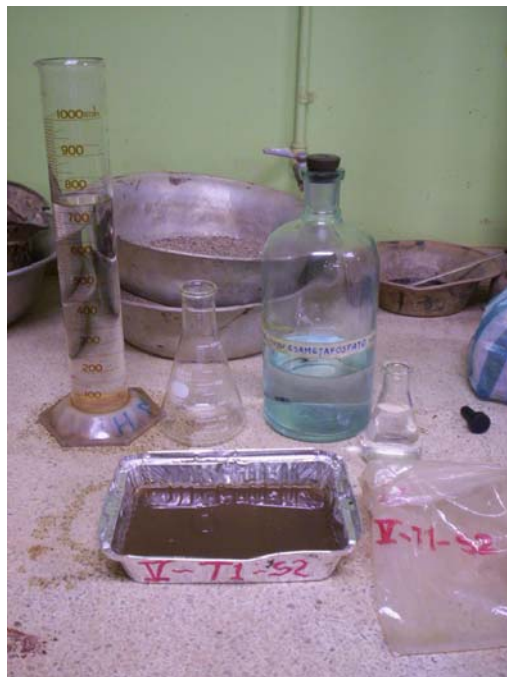
Figura 21, Preparación de muestra para Granulometría de finos.
