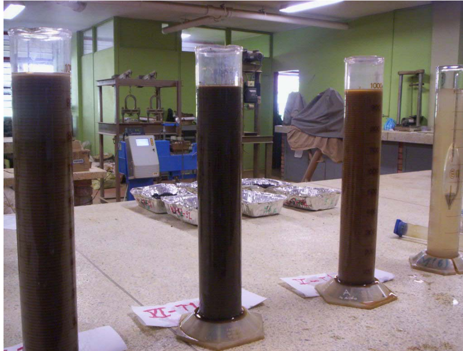
Figura 19, Probetas e Hidrómetro, en análisis fino granular (Hidrometrías).
