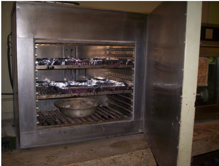
Figura 16, Horno con temperatura regulada de 110 \pm 5^{\circ}\text{C}
