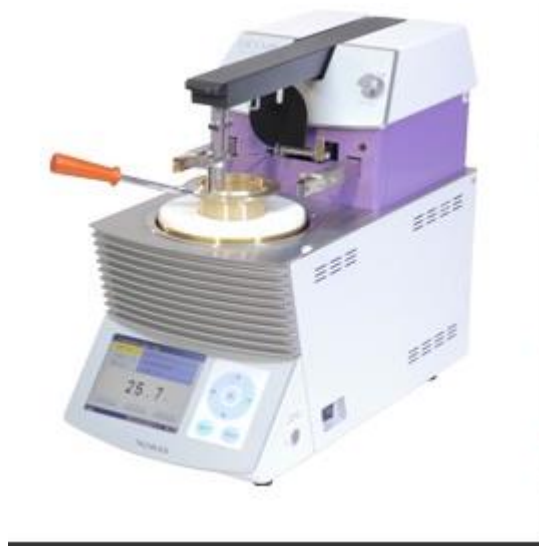
Figura 1. Equipo automático para punto de inflamación en copa abierta Cleveland, modelo ACO-8
