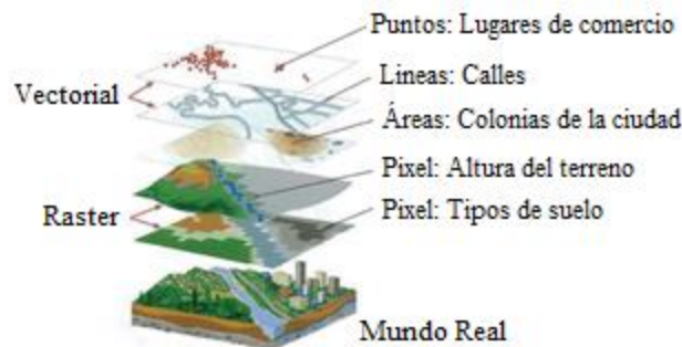
Figura 1. Modelos de datos: Vectorial y Raster . Fuente: [35].
