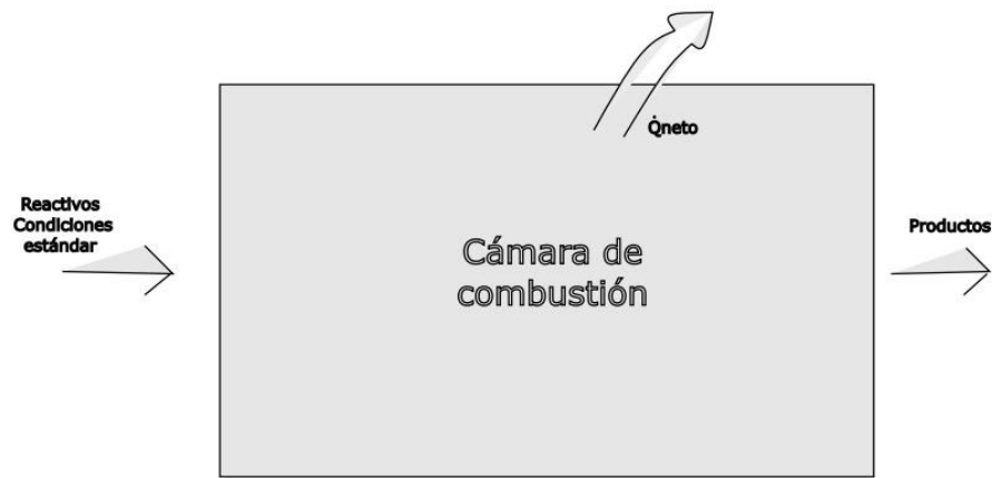
Figura 7. Modelo de análisis de la cámara de combustión.
