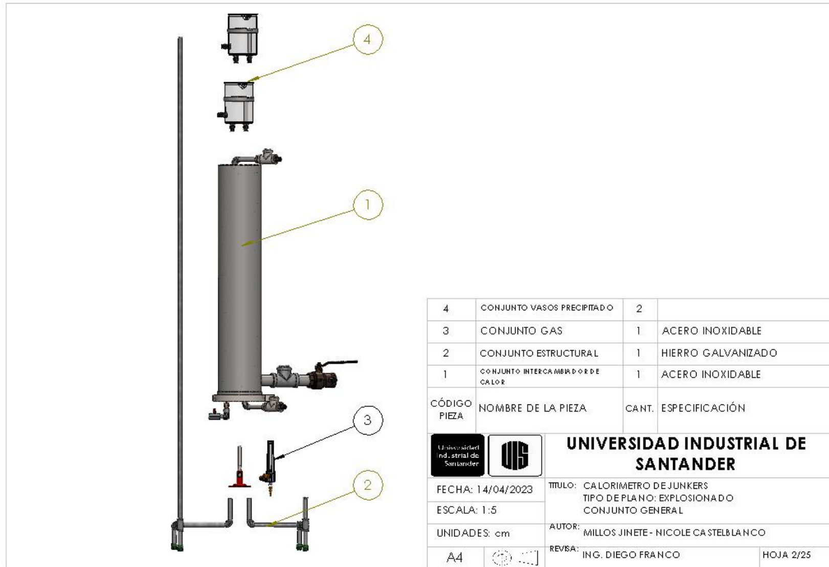
Figura 17. Plano vista explosionada conjunto general calorímetro.
