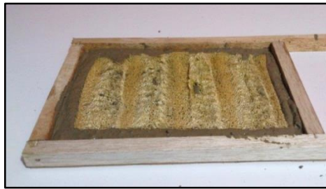
a) Colocación de la fibra (estropajo)
