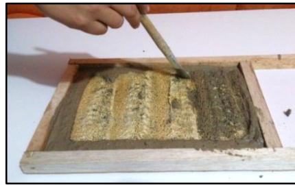
b) Recubrimiento de agua-cemento
