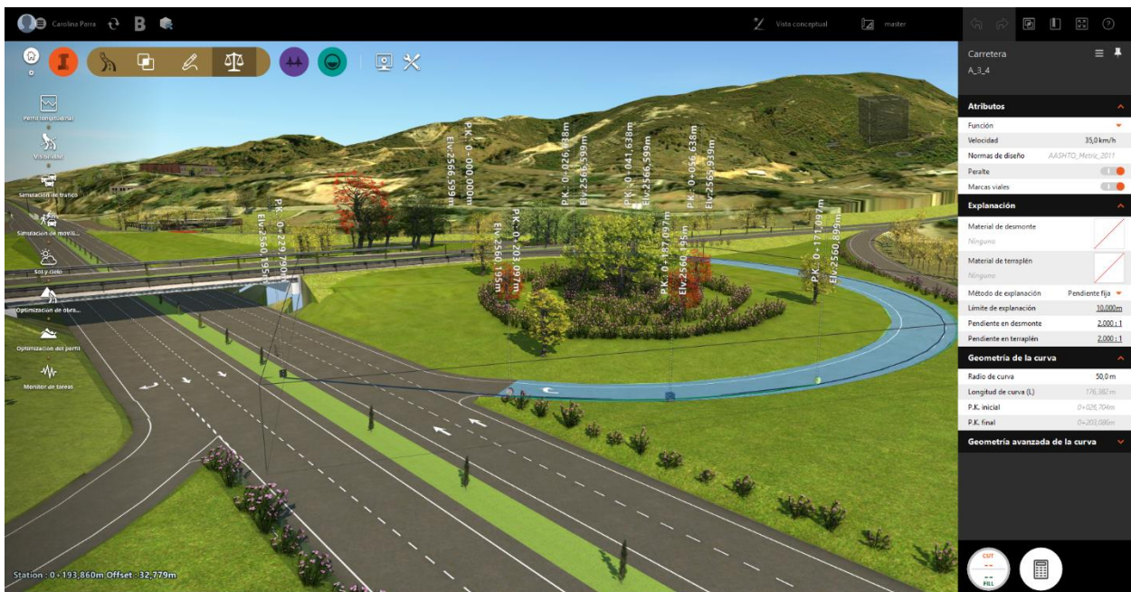
Figura 124. Diseño geométrico horizontal de los ramales de enlace de la intersección vial tipo trébol.
