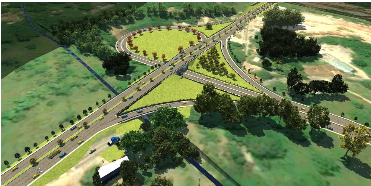
Figura 110. Vista general #2 del modelo BIM de la intersección vial a desnivel tipo trompeta.
