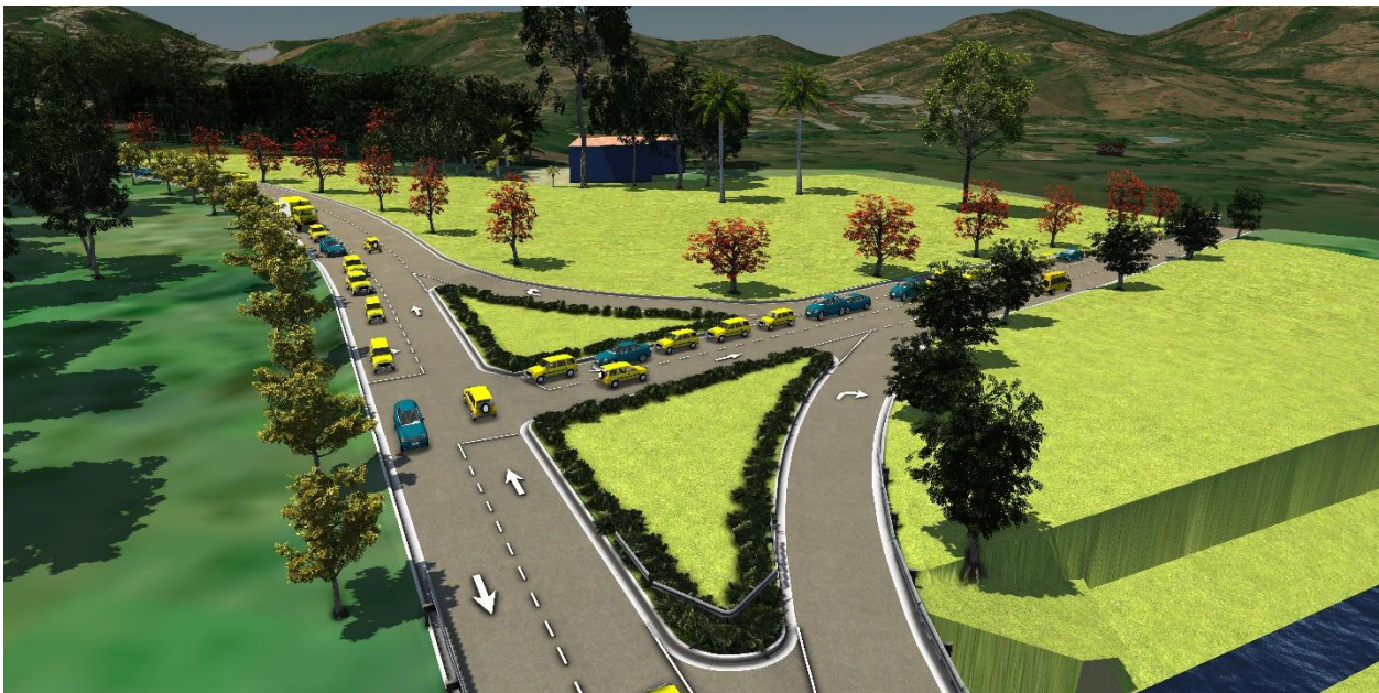
Figura 90. Intersección vial a nivel canalizada como opción a la intersección tipo trompeta analizada
