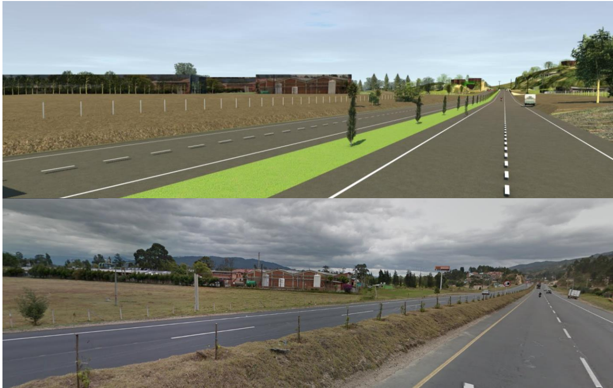
Figura 117. Modelo BIM de condiciones existentes vs fotografía 2 del sitio de la intersección vial a desnivel tipo trébol.
