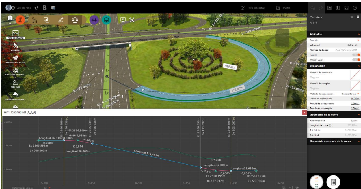
Figura 126. Diseño geométrico vertical de los ramales de enlace de la intersección vial tipo trébol.
