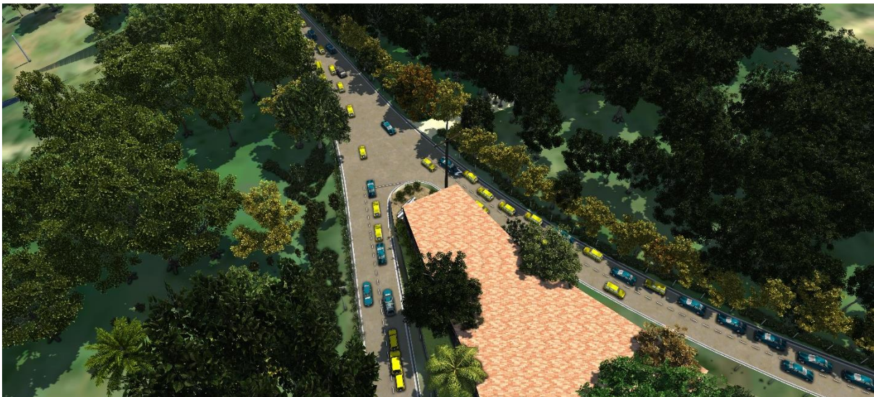
Figura 89. Modelo BIM de condiciones existentes en la intersección vial a desnivel tipo trompeta.
