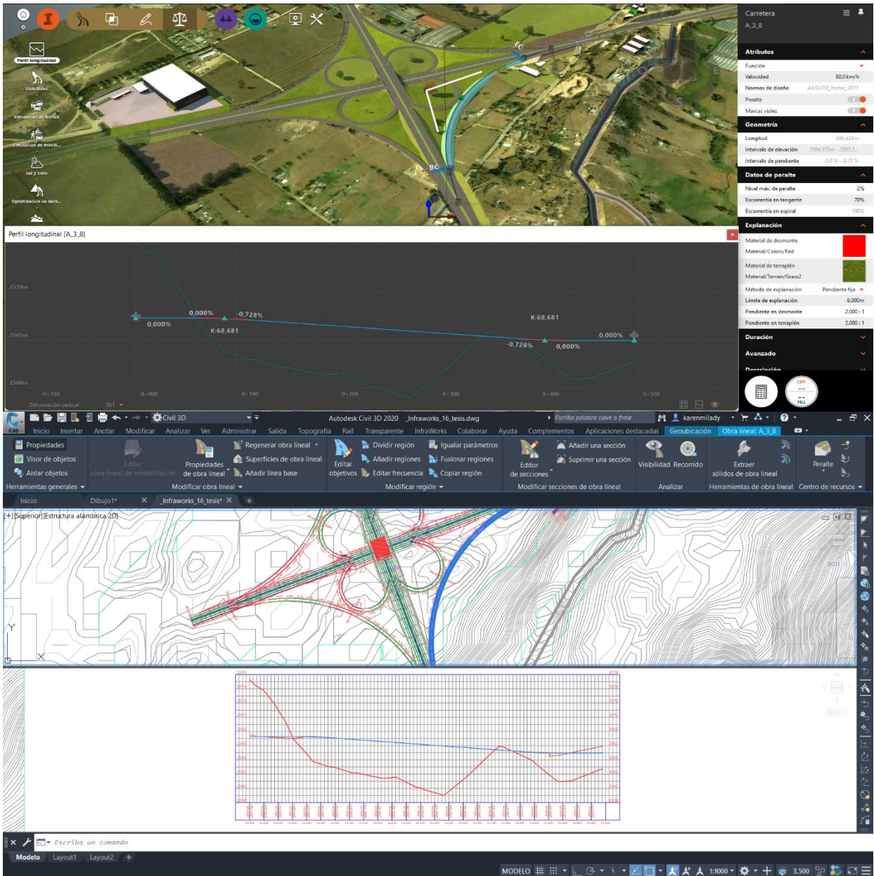
Figura 148. Perfil longitudinal de la metodología propuesta con modelo BIM vs perfil longitudinal de la metodología tradicional AutoCAD Civil 3D
