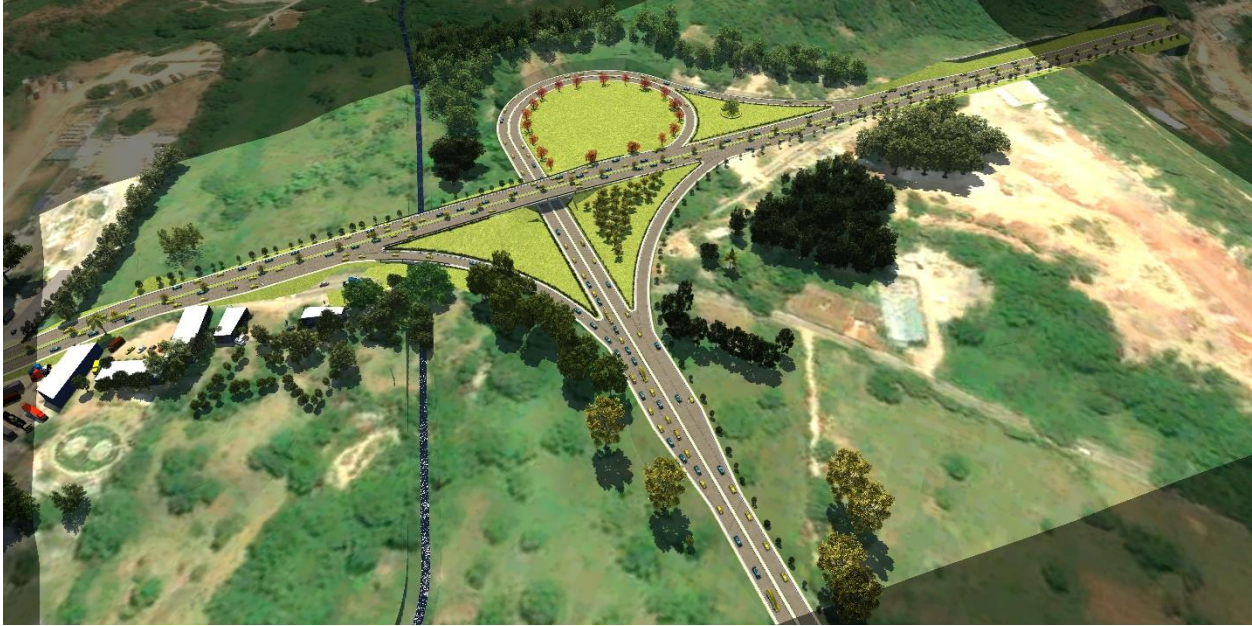
Figura 109. Vista general #1 del modelo BIM de la intersección vial a desnivel tipo trompeta.
