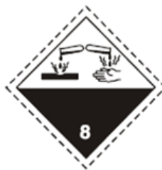
Figura 24. Rotulado de sustancias corrosivas.
