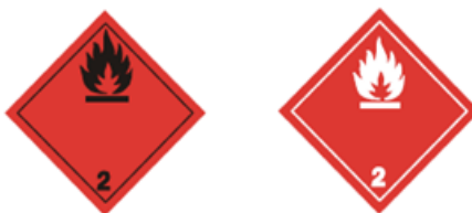
Figura 18. Rotulado de Gases.
