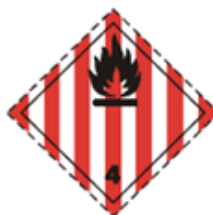
Figura 20. Rotulado de sólidos inflamables.
