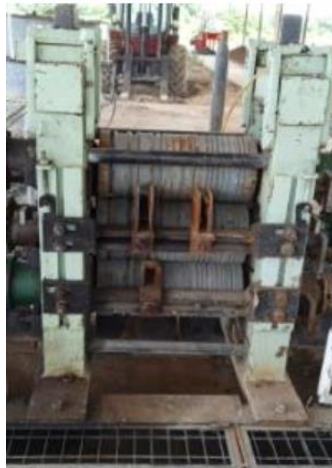
Figura 6. Torre de desbaste del tren de laminación
