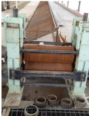
Figura 8. Torre de terminado del tren de laminación
