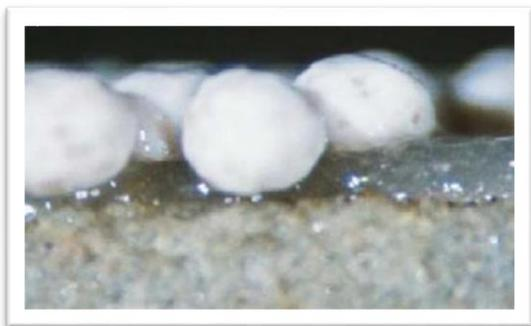
Figura 2. Fluido de fractura residual en el empaque de propante.
