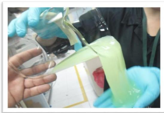
Fluido de fractura inyectado
