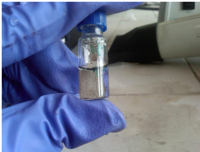
Figura 11. Dispersión de la muestra de carbón de la mina de Cúcuta en la mezcla de THF y Cloroformo
