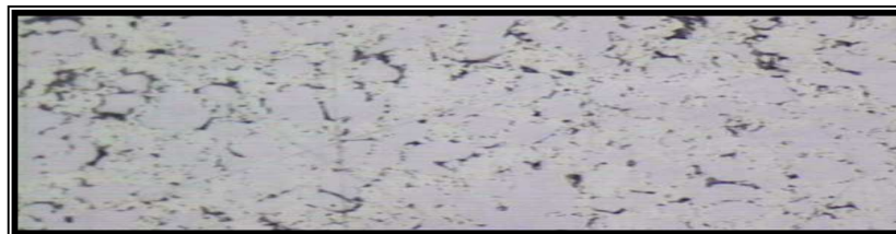
Figura 22. Fotografía de la aleación de oro blanco sin níquel y paladio tomada a 500 aumentos.
