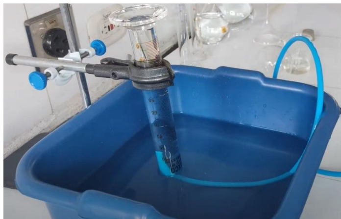
Figura 13 Medidor de volumen de gas
