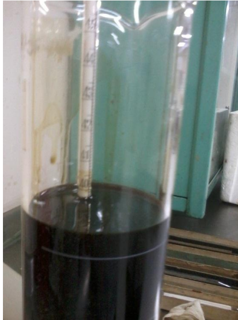
Figura A2. Hidrómetro estabilizado en el crudo
