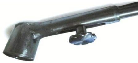
FIG. 124 brazo mecanizado con mecanismo de presión para elongación de los brazos externos.
