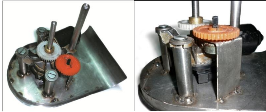
FIG. 118 Estructura mecánica montada en la base inferior de la carcasa en acero inoxidable.
