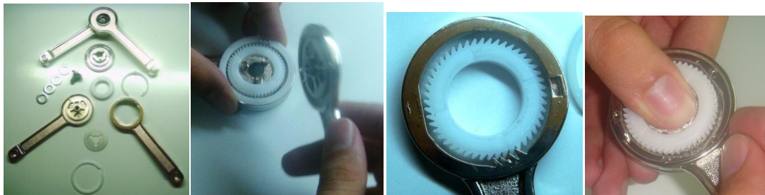
Fig. 48 Mecanismo de brazo mecánico, este mecanismo tiene un sistema mecánico de seguro que permite descansar el peso sin ser arrastrado.
