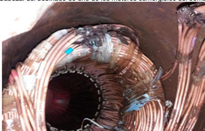
Nuevamente, se comprueba que no es posible realizar el control de las bombas lapicero con VFD sin la instalación de una sección de filtrado.
