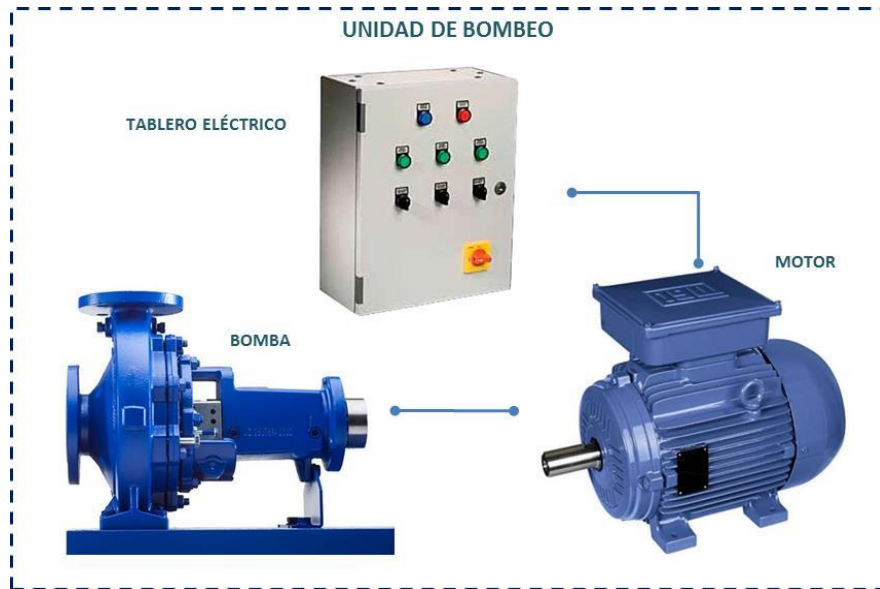
Figura 2. Unidad funcional bombeo.
