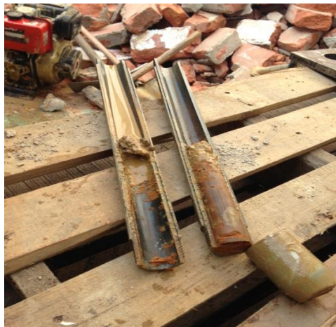
Fotografía 10. Tomamuestras con revestimiento (con Liner).
