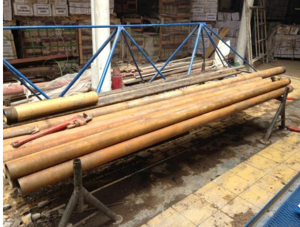
Fotografía 8. Varilla de 3 metros de longitud utilizada en el proyecto.
