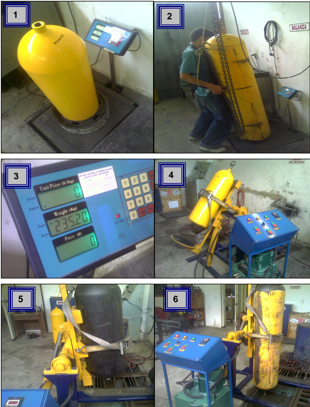
Figura 56. Fotos de la realización de pruebas prototipo. 1. Pesaje cilindro de 40 L; 2 y 3. Pesaje del cilindro de 120 L; 5 y 6 estado de inversión de los cilindros de 64 L y 120 L.
