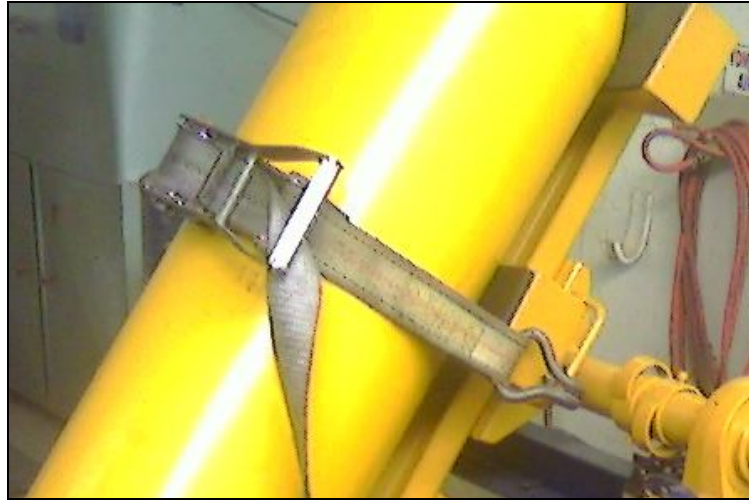
Figura 19. Detalle de la correa de ajuste del cilindro a la canastilla
