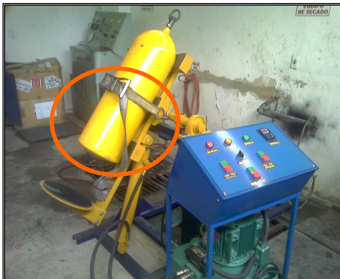
Figura 51. Detalle del ajuste del cilindro a la canastilla de la Inversora
