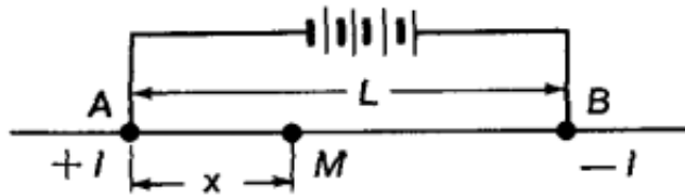
Figura 2. Explicación del cálculo de dos tomas de tierra semiesféricas. Tomado de: Iakubovskii and Liajov [1980]
