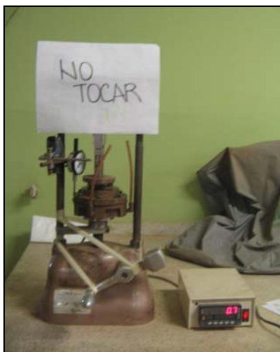
Figura 52. Maquina utilizada para medir la presión de expansión. Escuela de Ingeniería Civil, UIS Fuente: Investigación de los autores, 2005.
