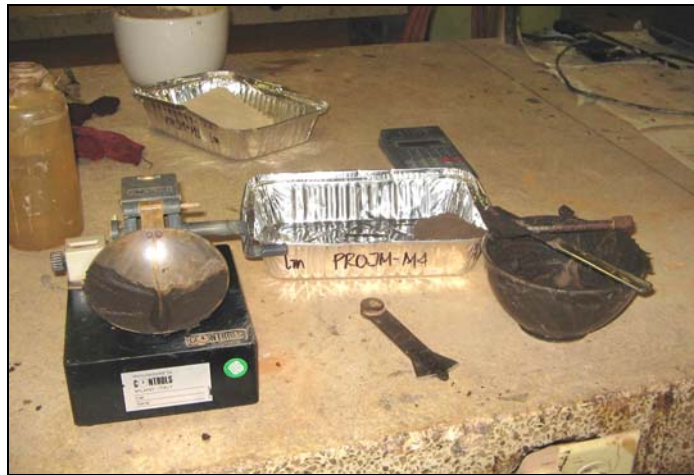
Figura 46. Implementos para laboratorio de Límites de Atterberg, Escuela de Ingeniería Civil, UIS Fuente: Investigación de los autores, 2005.
