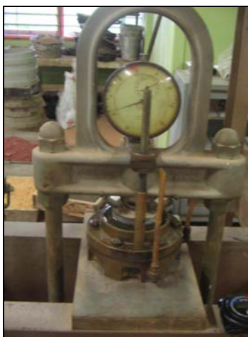
Figura 53. Consolidómetro donde se realiza el ensayo de Consolidación Unidimensional Fuente: Investigación de los autores, 2005.
