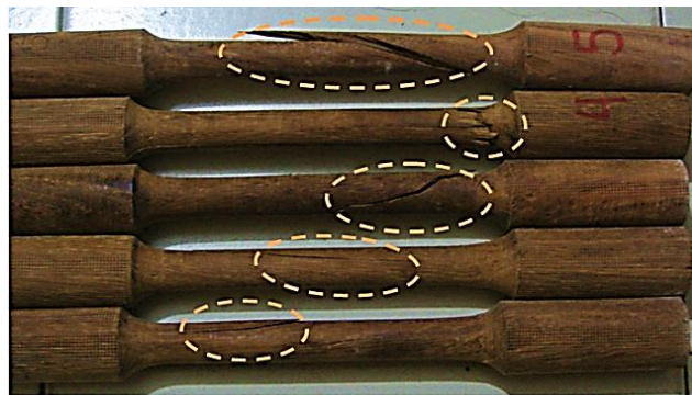
Figura 11. Falla en las probetas para ensayo a tracción paralelo a las fibras, sección circular.
