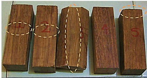
Figura 17. Falla en las probetas para ensayo a compresión paralelo a las fibras, sección circular
