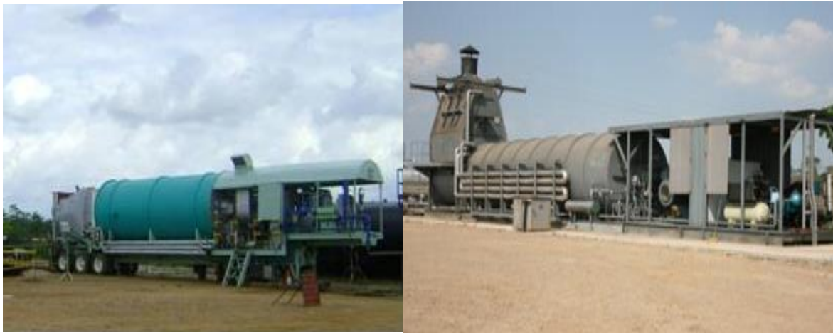
Figura 13. Generador de vapor móvil y estático. Mansarovar Energy
