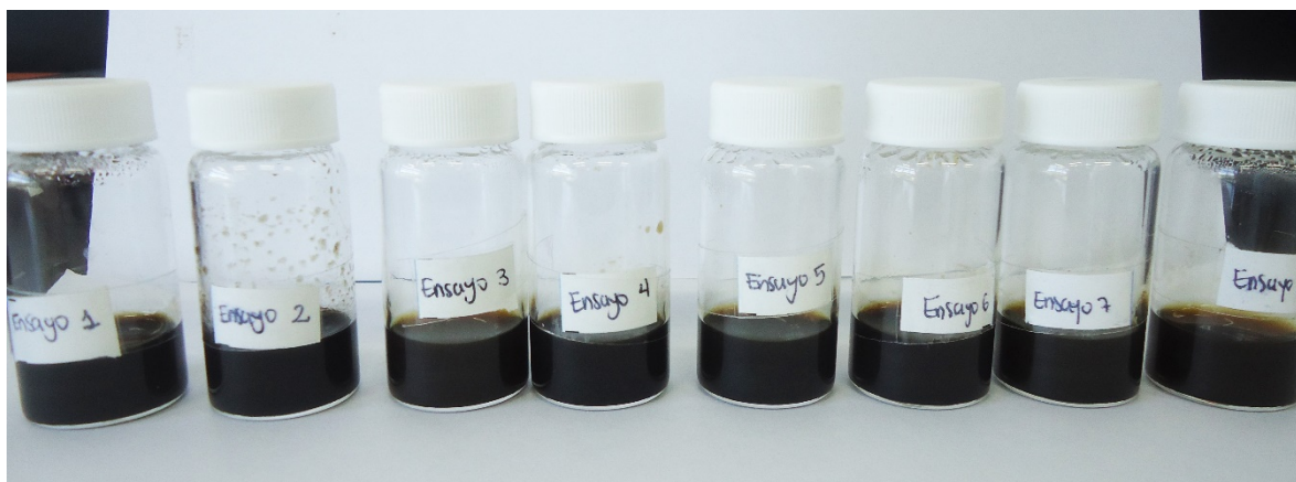
Figura D1. Soluciones de óxido de grafeno de los 8 ensayos del diseño experimental
