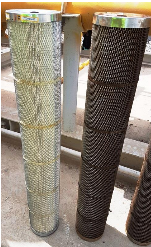
Figura 6. Comparación del estado de los cartuchos retirados del filtro Vs un filtro nuevo. Centro operacional Humay, Julio 2018.
