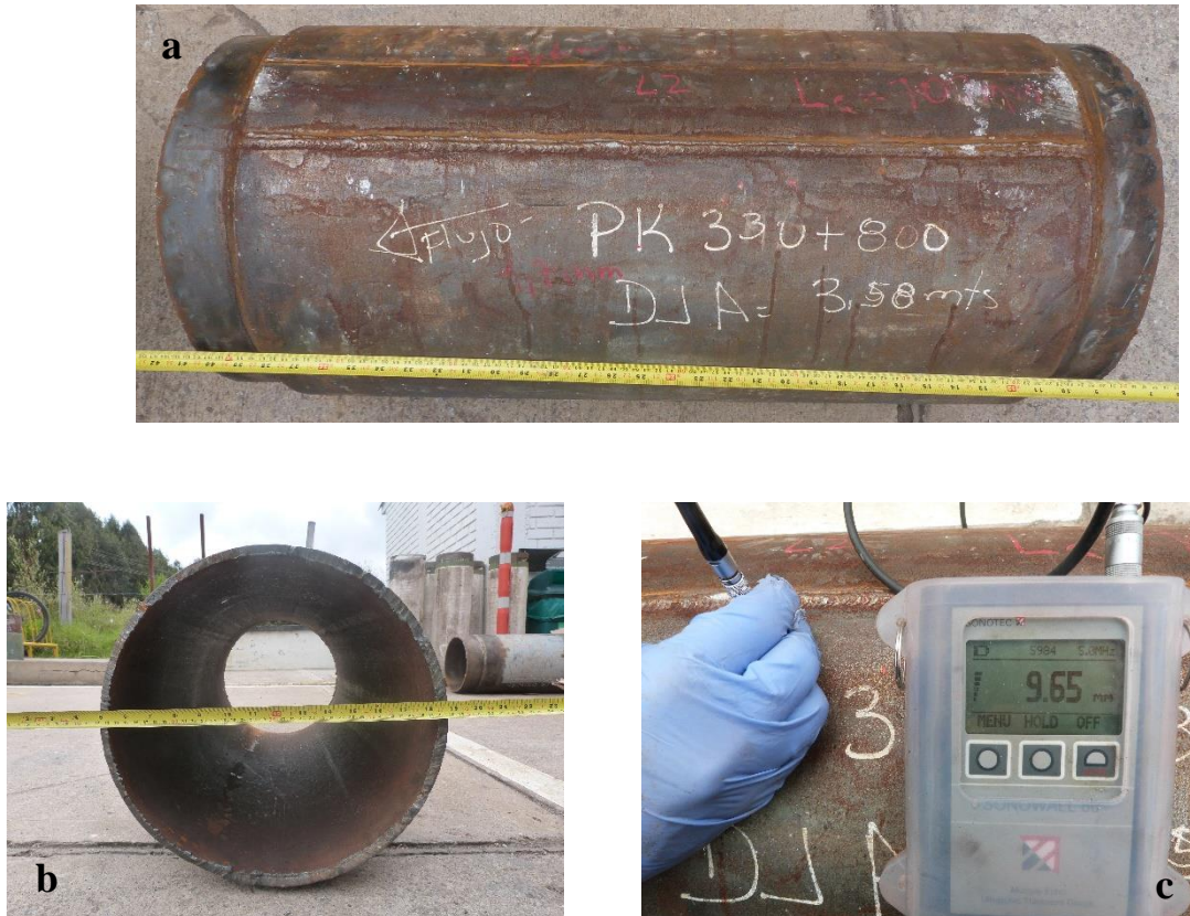
Figura 7. Dimensiones de sección de tubería recibida para análisis a.) longitud de tubería, b.) diámetro y c.) espesor de camisa
