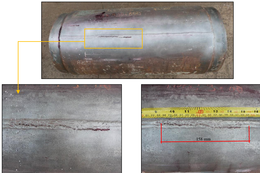
Figura 10. Indicaciones obtenidas mediante líquidos penetrantes
