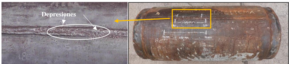
Figura 6. Depresiones superficiales en la cara del cordón
