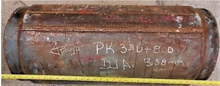
Figura 3. Camisa tipo B para análisis de fallas
