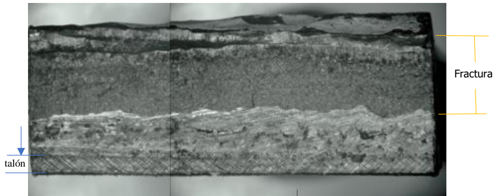
Figura 21. Superficie de fractura sección 4
