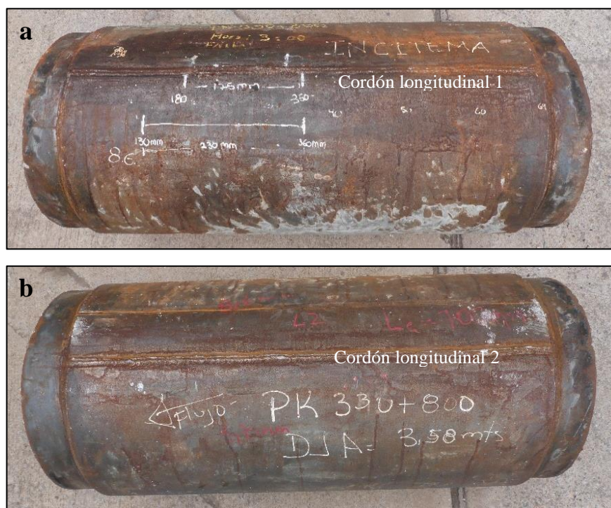
Figura 5. Estado superficial de la sección de tubería recibida para análisis a) cordón longitudinal con anomalía (cordón 1) y b) cordón longitudinal a 180° de anomalía (cordón 2).
