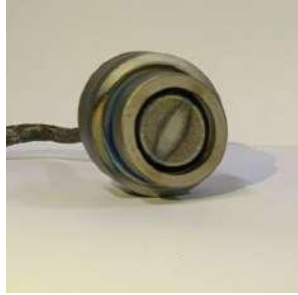
(a) Diseño típico. Se observa la rejilla utilizada para emplear el potencial de repulsión.
