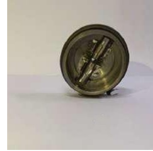
(b) Variante de la sonda. Se observa la configuración de imanes para crear la trampa magnética para los electrones.
