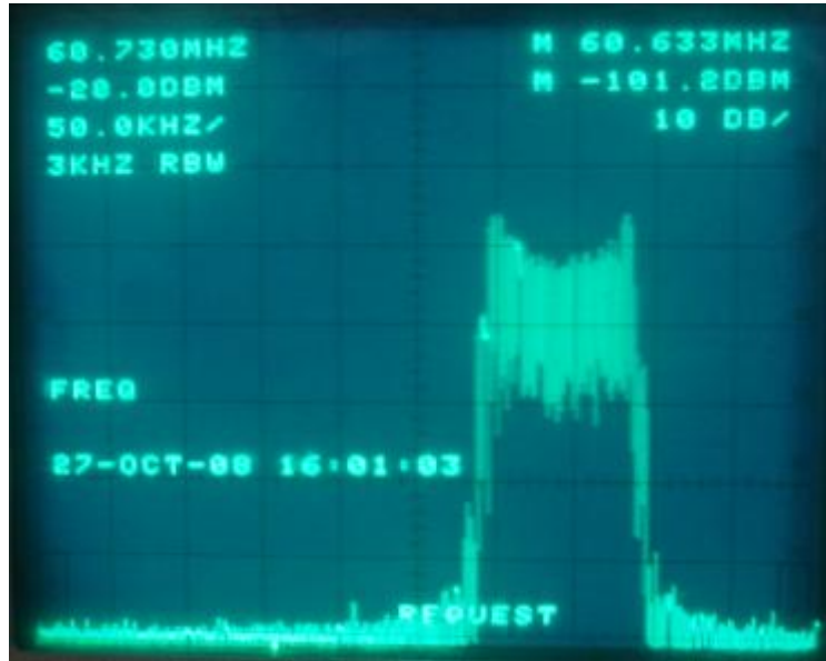
Figura 31: Señal de FM trasladada con el Mezclador UPC2756TB a 60.7MHz.
