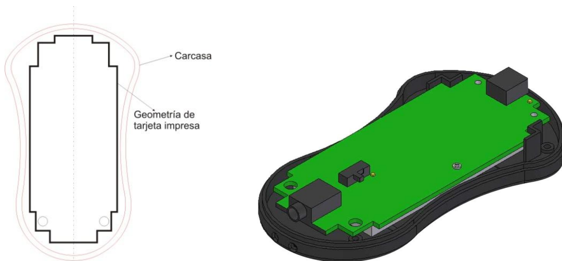
Figura 36: Circuito impreso a partir de la forma de la carcasa.
