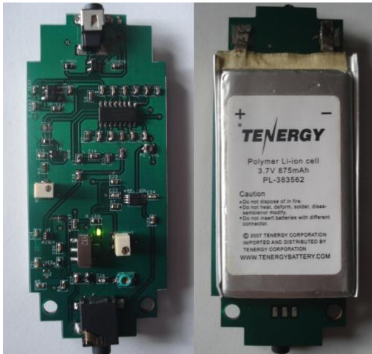
Figura 45: Circuito impreso físico del diseño con montaje final de las partes electrónicas Anverso y reverso
