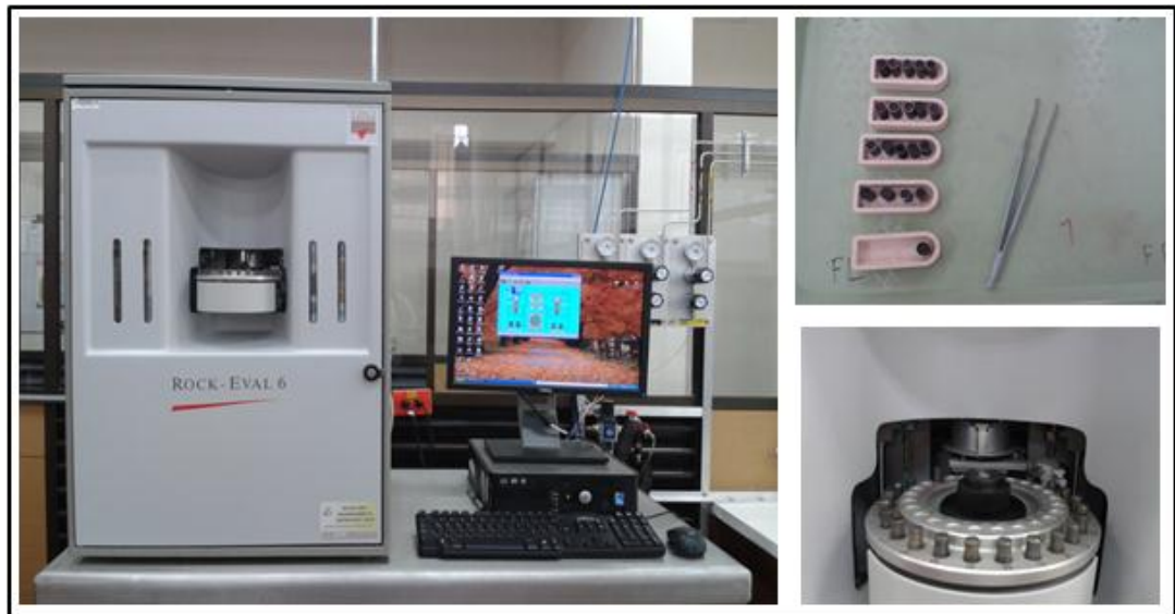
Figura 14. Analizador anhídrido de muestras de roca y suelos Rock Eval 6.
