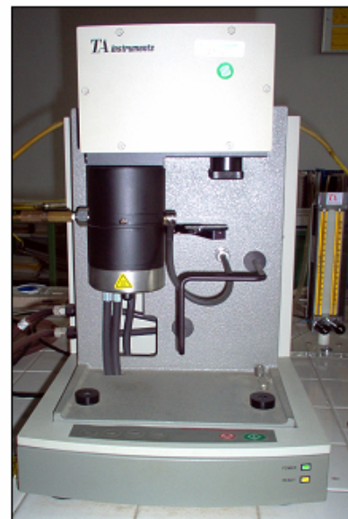
Figura 20. Analizador termogravimétrico TGA 2050
