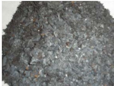
Figura 1 Fotografía del material ferromagnético (calamina)
