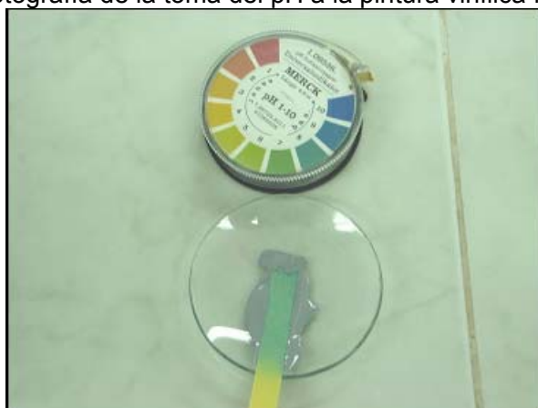
Figura 29. Fotografía de la toma del pH a la pintura vinílica ferromagnética
