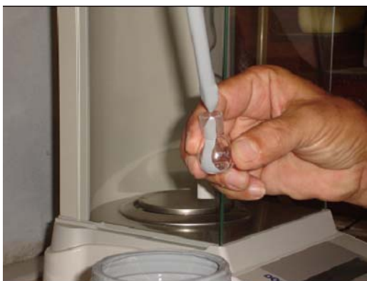
Figura28. Fotografía de la toma de la densidad a la pintura vinílica ferromagnética
