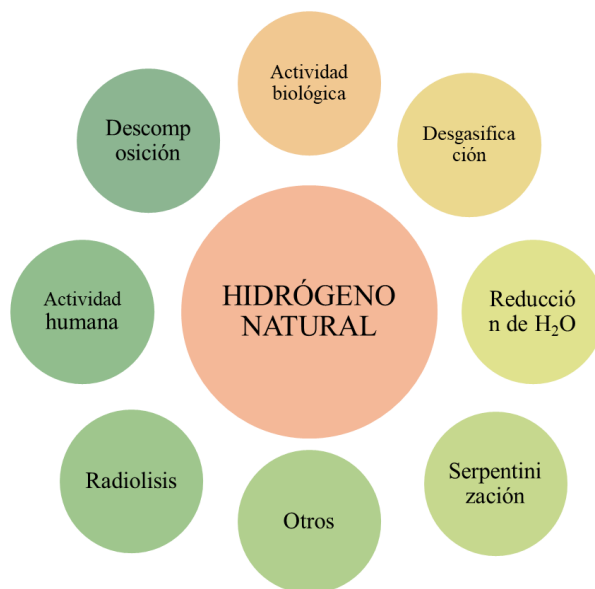
Figura 10 Diferentes hipótesis sobre el origen de los depósitos naturales de hidrógeno
