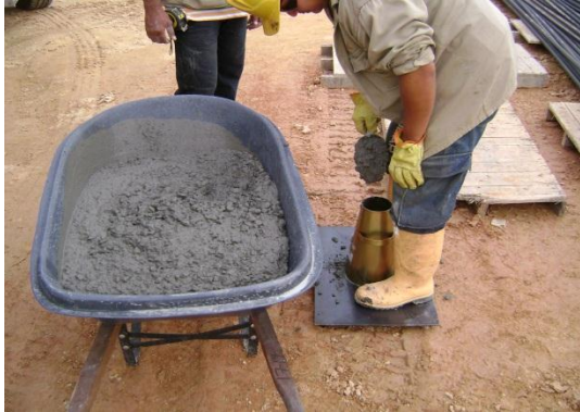
Figura 5. Prueba de asentamiento
