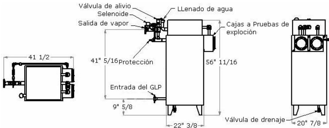
Figura 17. Dimensiones de los vaporizador de baño de agua eléctricos.
