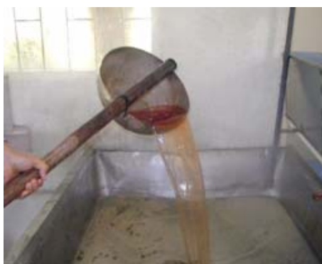
Figura 30. Adición de solución de Balso al jugo sin clarificar.
