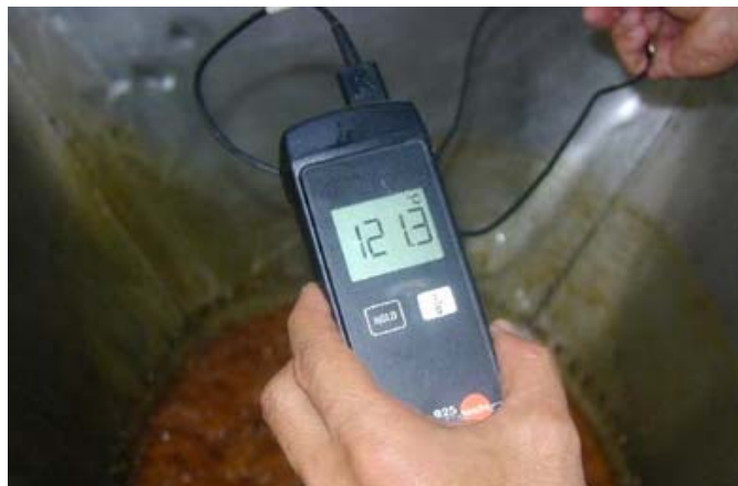
Figura 35. Punteo de la panela utilizando termómetro digital.
