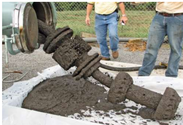
Figura 3. Resultados de la limpieza mecánica de una tubería de crudo.. Adaptado de: Thota & Onyeonuna, 2016
