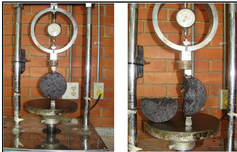
Figura 4-5 Ensayo de sensibilidad al agua por tracción indirecta
