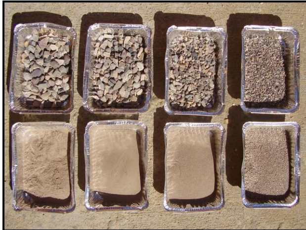
Figura 4-1 Agregados de la mezcla seleccionada
