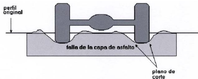
Figura 2-1 Deformación plástica en la capa asfáltica
