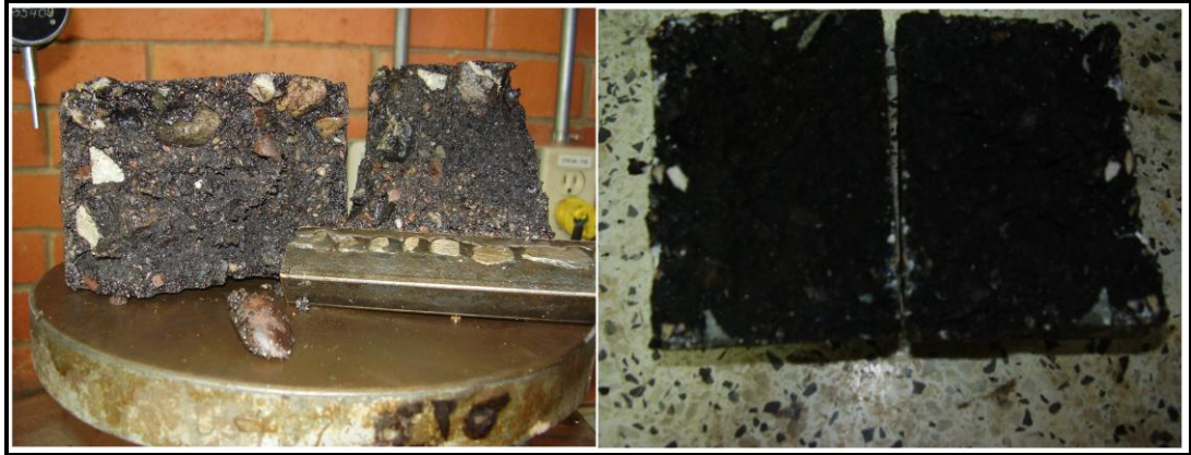
Figura 4-6 Efecto del agua sobre las briquetas
