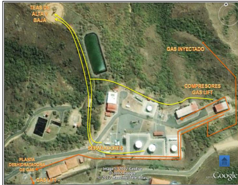
Figura 3. Detalle de planta Batería Norte
