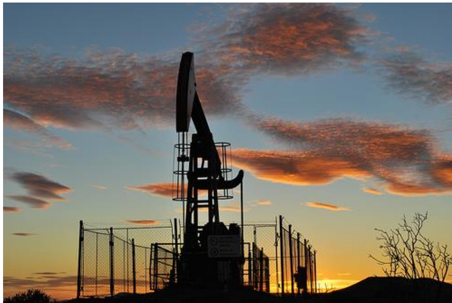
Figura 7. Unidad BMC con encerramiento en malla
